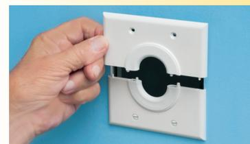
Utilisez-les telles qu'expédiées; avec une ouverture de 38,1 mm (1,5 po) pour le **CESP1** à un seul module et une ouverture de 50,8 mm (2 po) pour le **CESP2** à deux modules. Ou ajoutez l'une des bagues fournies pour modifier la taille de l'ouverture.
