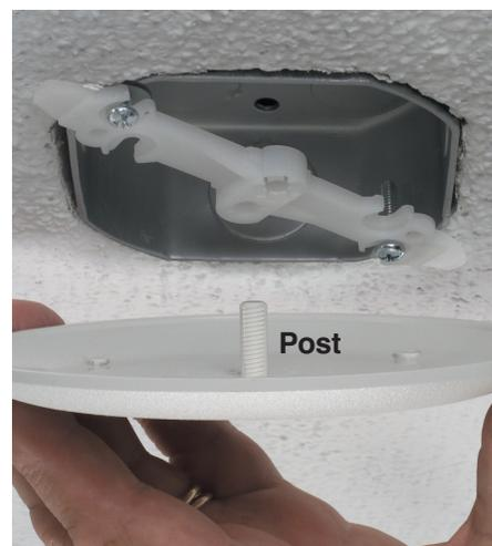
3 Sur les plafonds plats, poussez la tige filetée dans l'ouverture « A » pour poser le couvercle. Sur les plafonds texturés ou irréguliers, vissez la tige dans l'ouverture « B » jusqu'à ce qu'elle soit bien serrée.
