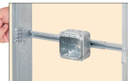
Fixez la SliderBar sur les montants à l'aide des vis n° 8 x 1/2 po. Positionnez la boîte sur la barre. Serrez les vis à l'intérieur de la boîte.
