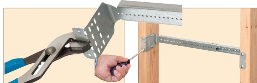
Pliez les extrémités du support à la marque de 6,35 cm pour une utilisation sur un panneau mural de 1,27 cm ou 1,58 cm d'épaisseur. Les extrémités peuvent également être pliées à 90 degrés ou en arrière (180 degrés), selon les besoins d'installation à l'intérieur.
